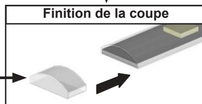
**IMPORTANT,** appliquer une noisette de silicone translucide à l'intérieur de l'embout de finition pour rendre l'assemblage étanche.
