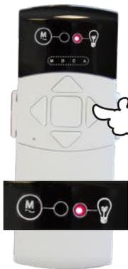
1 - Appuyer sur droite pour sélectionner le canal des LED
