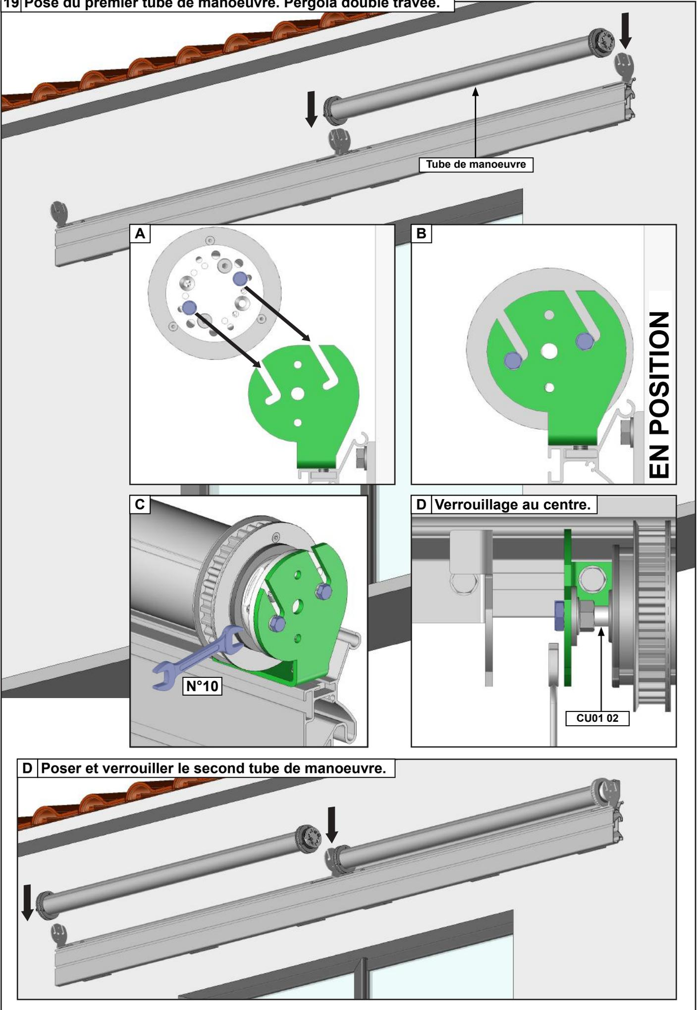
**20 Verrouillage des supports tube de manœuvre. Pergola double travée.**
