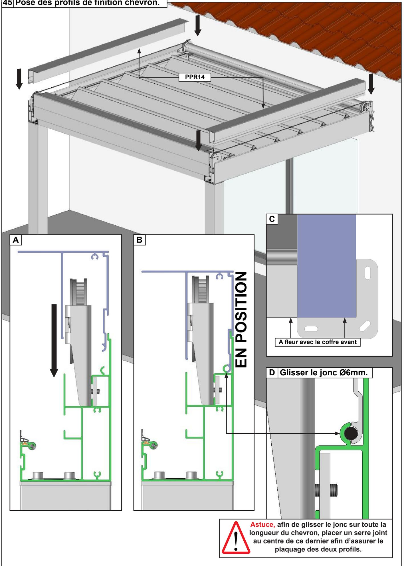
46 Pose des profils de finition chevron. Pergola double travée.
