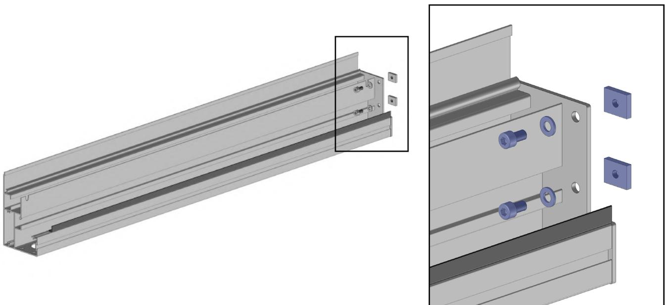
22 Pose des 3 kits de fixation KITPPR19 de la travée droite. Pergola double travée.
