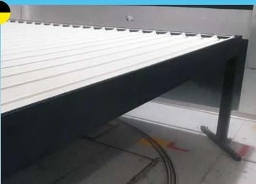
La pergola a subi différentes incidences du vent pour différentes **configurations d'ouverture / fermeture** des lames jusqu'à des **vitesses élevées**. Lorsque le vent agit perpendiculairement aux lames, celles-ci sont nettement plus sollicitées et les déplacements peuvent atteindre des niveaux élevés. **Aucune fragilité des lames** et de la **fixation** n'a été notée à l'issue de ces essais.
